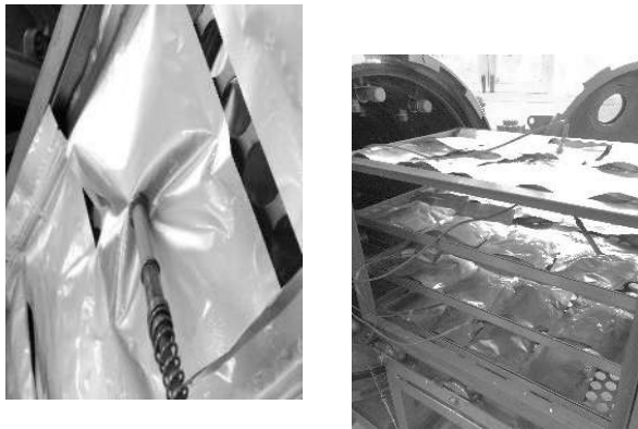
ภาพที่ 1 กระบวนการฆ่าเชื้อด้วยความร้อนของตัวอย่างแกมมาบรจุรีทอร์ตเพาซ์
